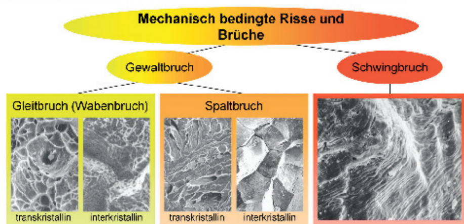
Bild 1: Mikrostruktur der Bruchfläche mechanisch bedingter Risse und Brüche.
